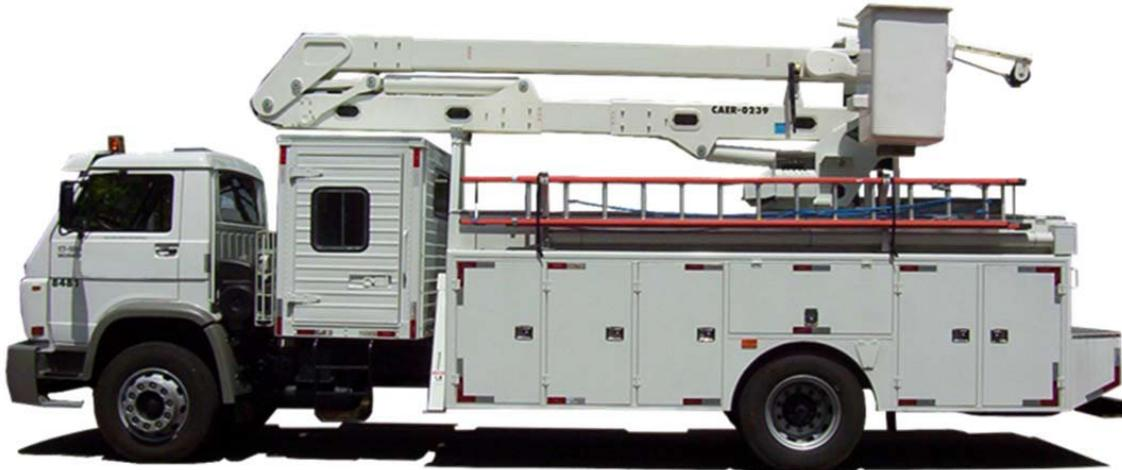
**CESTA AÉREA:** Equipamento veicular destinado à elevação de pessoas para execução de trabalho em altura, dotado de braço móvel, articulado, telescópico ou misto, com caçamba ou plataforma, com ou sem isolamento elétrico, podendo, desde que projetado para este fim, também elevar material por meio de guincho e de lança complementar (JIB), respeitadas as especificações do fabricante.
